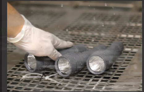
Water Spray Test (EN 60529 IP TEST)
